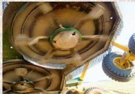
Das Messersystem hat einen großen Saug- und Zerkleinerungseffekt – mit dem Ergebnis, dass Staub mit den zerkleinerten Strohresten vermischt
