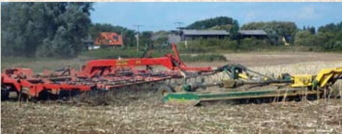
Kombination 620 mit Star Cut Väderstadtstriegel mit Walze. Ein Arbeitsgang – viele Vorteile wie reduzierter Schimmelruck, 4 x besseres Keimen von Verlustsamen und Unkräutern, dadurch reduzierter PSM - Einsatz. Außerdem schnellere Stoppelverrottung und kontrollierte Freigabe von Nährstoffen aus den Pflanzenresten. (Foto oben)
