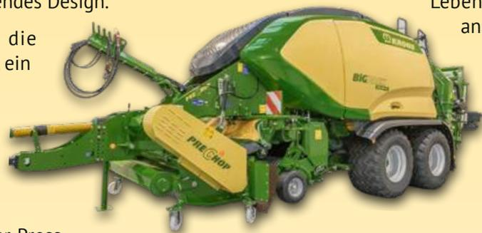
Weitere Optimierungen sind die nach hinten offene Pick Up, Garnreste entfernen sich dadurch deutlich einfacher. Die Achsen sind ausschließlich aus dem Hause BPW, die Gelenkwellen kommen von der Firma Walterscheid.
